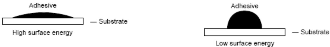
La ilustración demuestra el efecto de la energía superficial en el contacto interfacial del adhesivo. Los materiales de energía superficial elevada acercan más al adhesivo para una fuerza de unión elevada.
