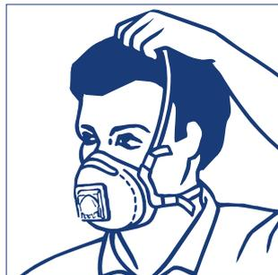
2. Coloque la mascarilla sobre la cara. Pase la banda inferior por la cabeza hasta la nuca y coloque la banda superior en la coronilla. Compruebe que no quedan retorcidas.
