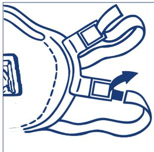
1. Pase la banda de ajuste superior por las hebillas superiores. Repita la operación con la banda y hebillas inferiores.
