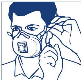
5. La tensión de las bandas se puede disminuir, sin quitarse la mascarilla, presionando hacia fuera la parte interior de las hebillas. Si no puede conseguir un ajuste correcto, no entre en el área contaminada. Consulte a su supervisor.
