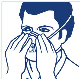
6. El ajuste de la mascarilla a la cara debe comprobarse antes de entrar en la zona contaminada. Para ello realice las siguientes pruebas:
