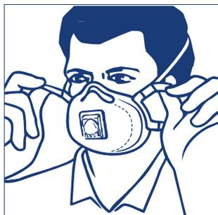
3. Ajuste la tensión de las bandas, tirando de sus extremos como se indica en la figura.
