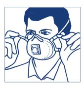
3. Ajuste la tensión de las bandas, tirando de sus extremos como se indica en la figura.
