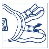
Pase la banda de ajuste superior por las hebillas superiores. Repita la operación con la banda y hebillas inferiores.
